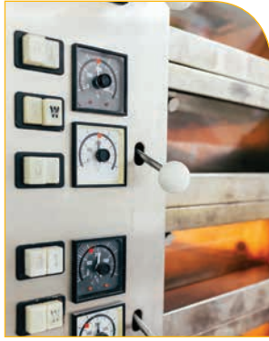
Görsel 5.2: Bimetalik tip termometre
