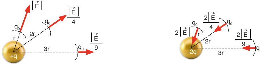
Şekil 2.2: +q ve -2q yüklü cisimlerinin oluşturduğu elektrik alan vektörlerinin yönü ve büyüklüğü
