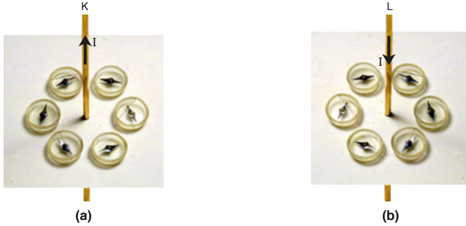
Şekil 2.39: Akım geçen iletken düz tel ve pusula ibreleri
