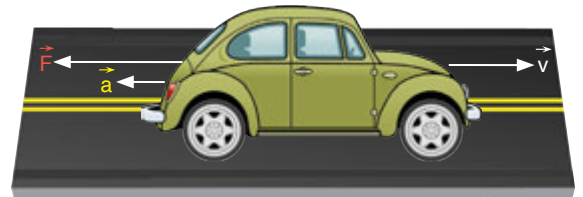
Şekil 1.45: Düzgün yavaşlayan harekette hız ivme ve kuvvet vektörleri
