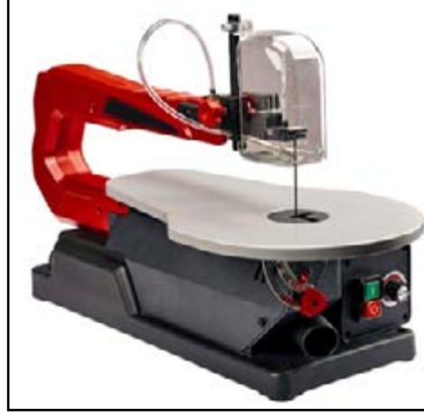
Şekil 4. Masa tipi deкупaj makinesi
