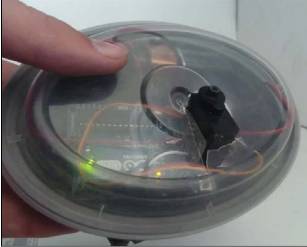
Resim 4. Motor ile kaseyin birleştirilmesi
