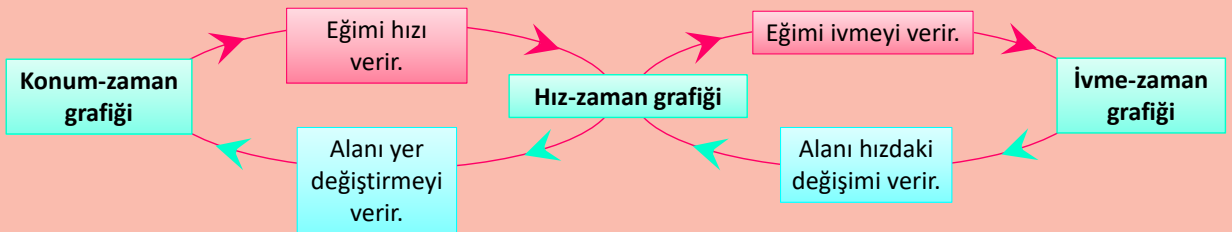
Şekil 8: Konum-zaman grafiği, hız-zaman grafiği, ivme-zaman grafiği arasındaki dönüşümler
